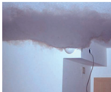
Coanda-Effekt bei Weitwurfelementen: die Luft streicht entlang der Decke weit in den Raum hinein, hier im Nebeltest sehr gut zu erkennen (links).
