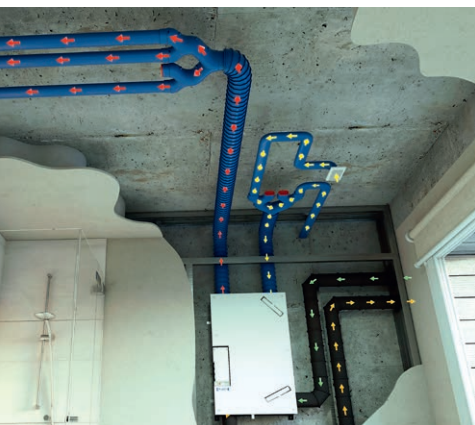
Lüftungsgerät über dem WC und Verteilung unter der Baddecke – kein Platzverlust
